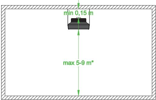
Vid högre värmebehov, kan flera enheter installeras i samma utrymme. För att säkerställa ett korrekt luftflöde, är det nödvändigt att upprätthålla de rekommenderade avstånden mellan värmarna, som visas i följande figur.
