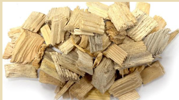
Optimalt P16B (G30)-flis, mycket väl lämpad för pyrolysisdrift.
