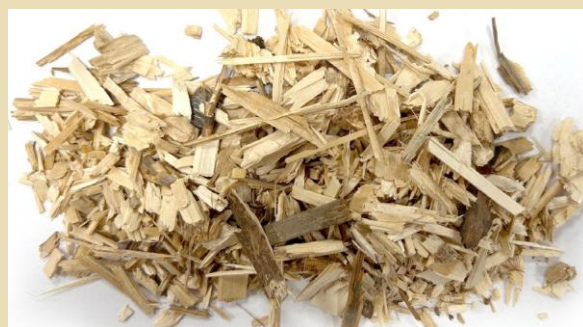
Mycket fint P16B (G30) flis som är mindre lämpligt för pyrolysisdrift.
